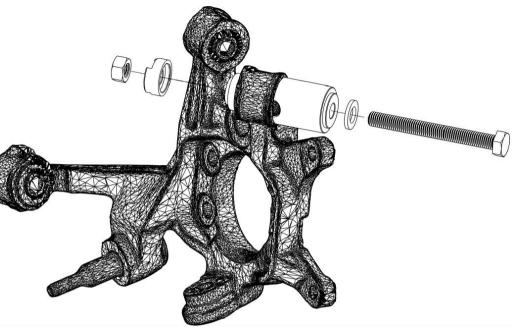
5. SETUP THE TOOL AS SHOWN ABOVE USING THE LONGER BOLT.
